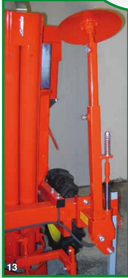
12 - Griglia sul fondo della tramoggia (Opt.) Grille sur le fond de la trémie (Opt.) Grate on the hopper's bottom (Opt.) Sieb über den Boden des Bunkers (Opt.) 13 - Tracciafila idraulico (Opt.) Traceur hydraulique (Opt.) Hydraulic row maker (Opt.) Hydraulische Spuranreiber (Opt.)
